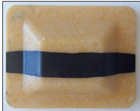
Abb.1.: SMC-Demonstrator der ersten Generation mit CFK-Verstärkung
