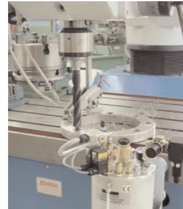
Abb.11: MMS-Auftragssystem (Foto: Fa. Link, Karlsruhe)
