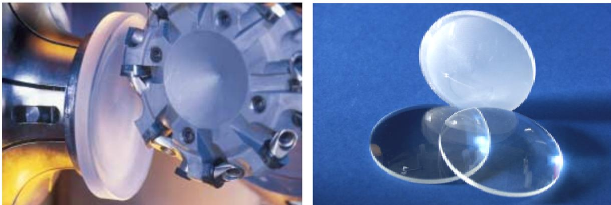
**Abbildung 11.4.17:** Das linke Bild zeigt einen Blick in den Maschinenarbeitsraum mit Werkstück und Werkzeug (Quelle: Loh Optikmaschinen AG). Das Bild rechts zeigt Brillengläser (liegend: polierte Gläser) aus Kunststoff, die unter Einsatz einer Minimalmengenkühlung durch Drehfräsen bearbeitet worden sind
