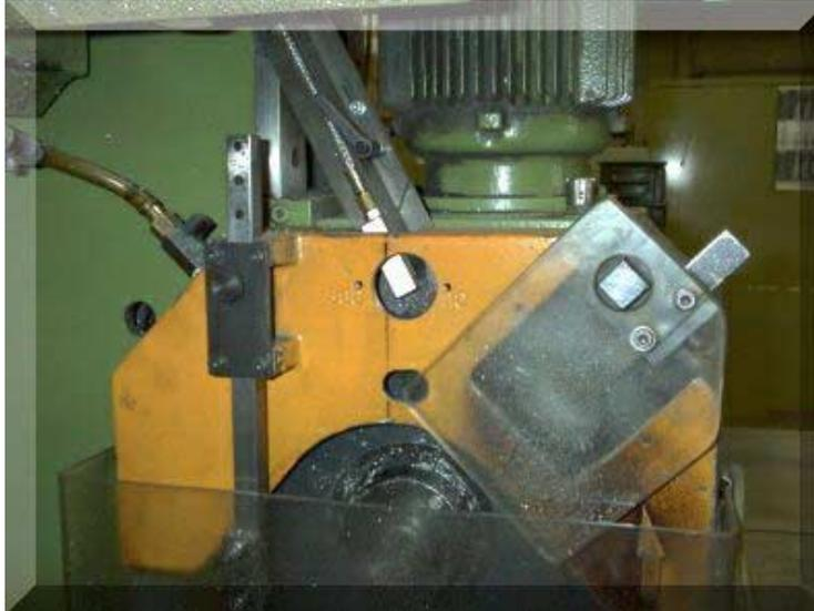
**Abbildung 11.4.20 Eine von drei in einem Unternehmen von Emulsion auf MMS-Technik umgerüsteten Kreissägen**
