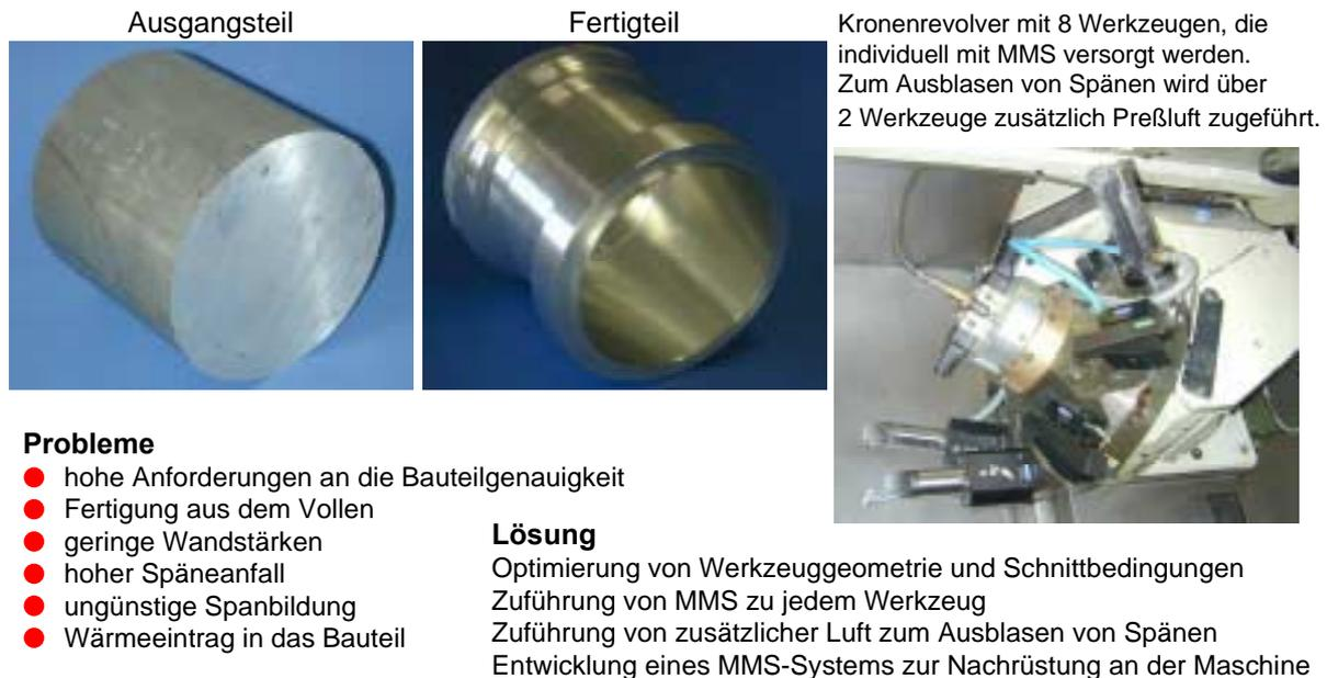
**Abbildung 11.4.3: Drehen eines Aluminiumgehäuses aus dem Vollen**
