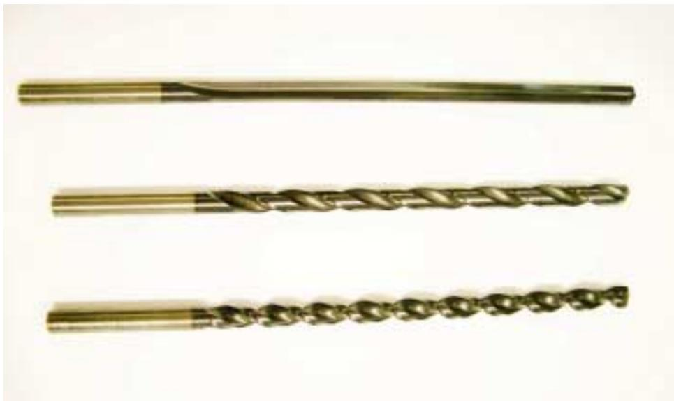
**Abbildung 11.3.27: Versuchswerkzeuge: geradgenutet, spiralisiert 30°, spiralisiert 40°**
