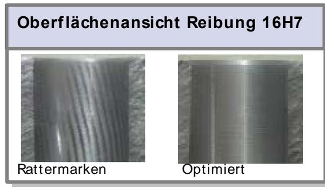
**Abbildung 11.3.10: Oberfläche der 16 H7 Bohrung im Trockenprozess**
