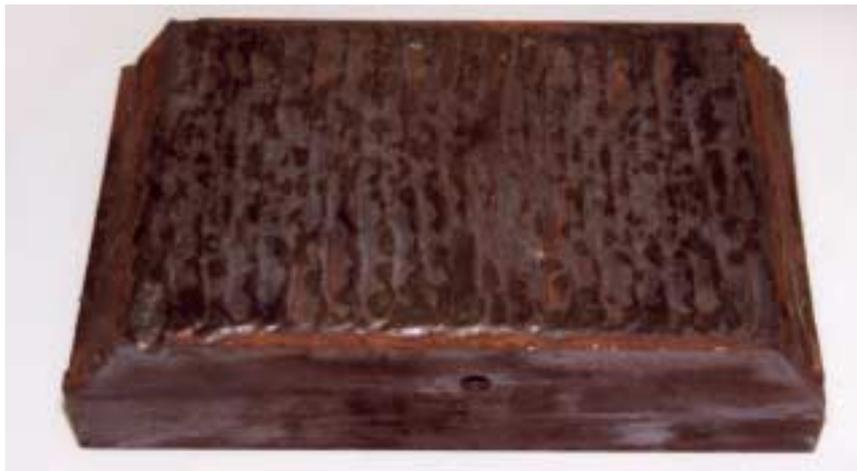
**Abbildung 11.1.14: Probewerkstück mit einer Stellite 21-Panzerung**
