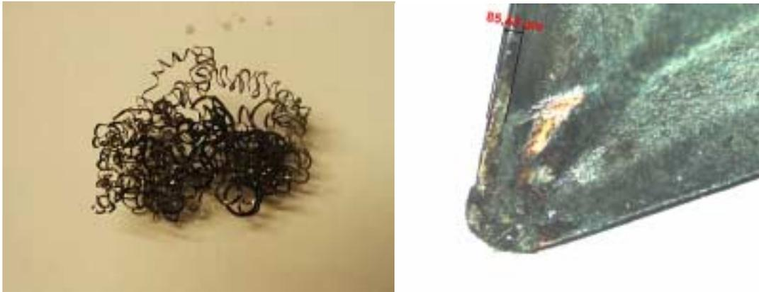
**Abbildung 11.3.23: Spanknäuel und Aufbauschneidenbildung**
