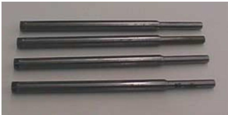
**Abbildung 11.1.11: Trockenfräsen von Werkzeugschäften**
