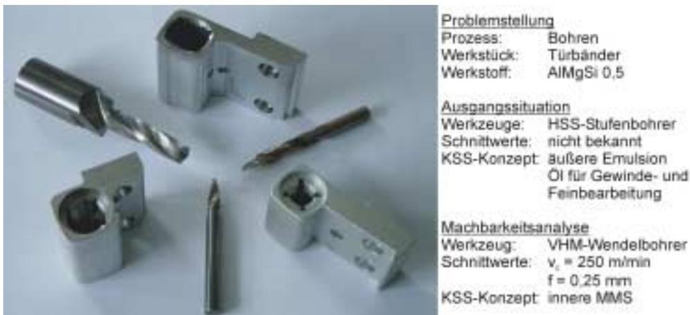
**Abbildung 11.2.6: Türbänder aus der Aluminium-Knetlegierung AlMgSi 0,5**
