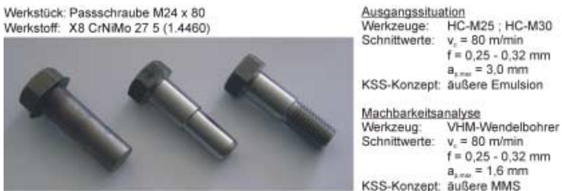
**Abbildung 11.2.10: Sechskant-Passschrauben aus X8 CrNiMo 27 5**
