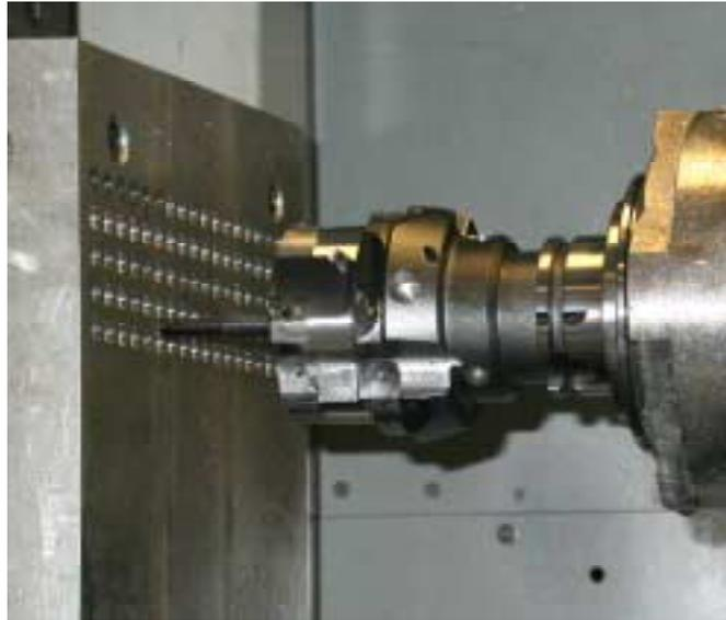
**Abbildung 11.3.7: Bearbeitungsversuche in AlSi9 Cu3**
