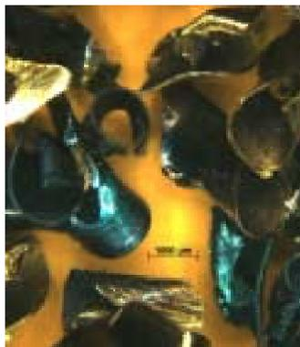
**Abbildung 11.3.5: Kurzbrechende Wendelspäne**
