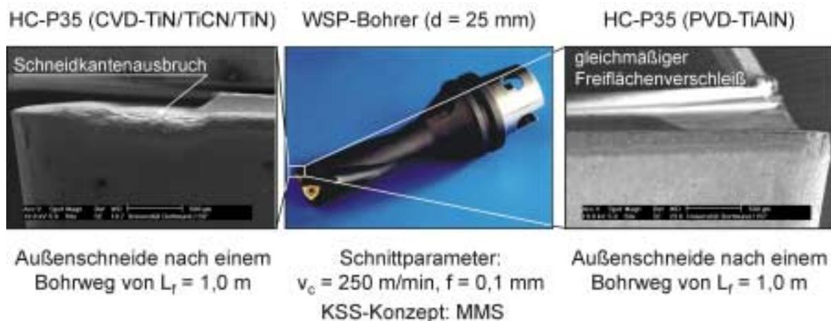
**Abbildung 11.2.4: Einfluss des Schneidstoffes und der Beschichtung auf die Verschleißausbildung beim Bohren von Gabellaschen aus dem Werkstoff**
