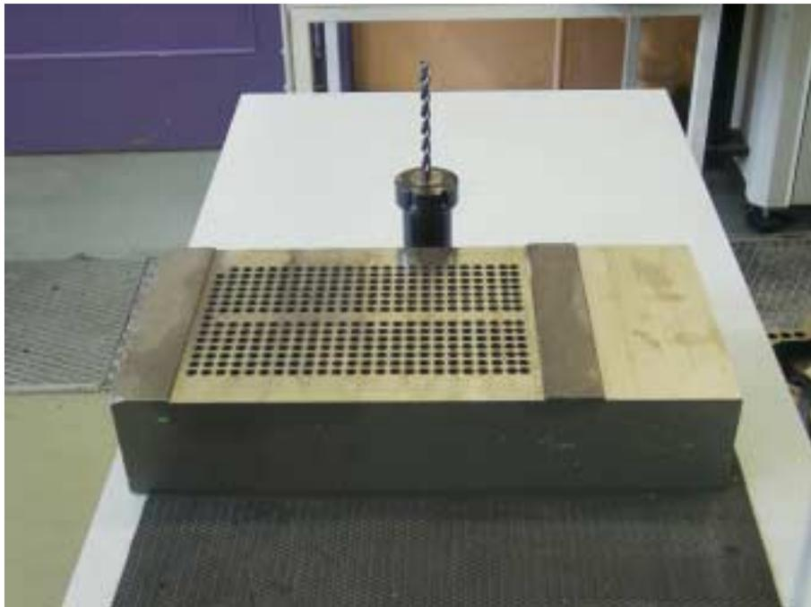
**Abbildung 11.3.29: Gussbramme und Bohrwerkzeug HSSE**
