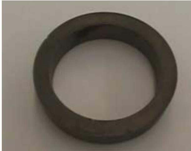
**Abbildung 11.1.22: Ring aus Sintermetall**
