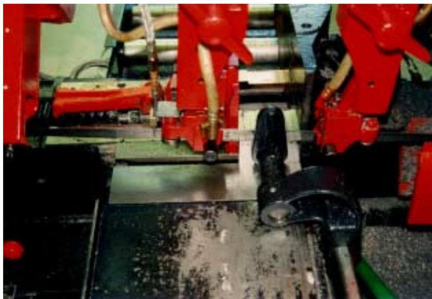
**Abbildung 11.1.23: Sägen mit Minimalmengenschmierung**
