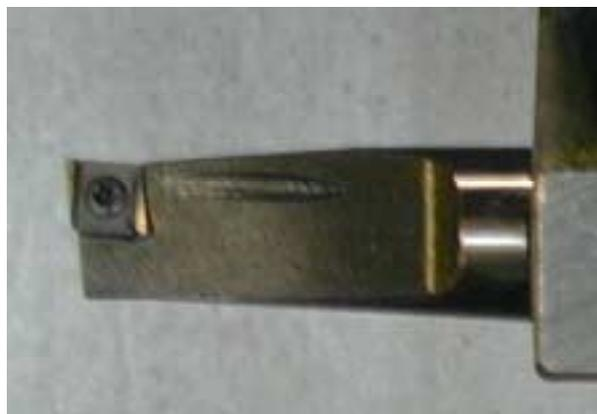
**Abbildung 11.4.2: Werkzeug mit einerodiertem Kanal zur inneren MMS-Zuführung**
