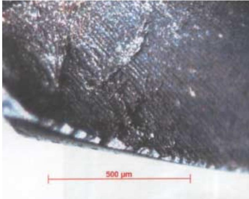
**Abbildung 11.3.2: Ansicht der Spanfläche und Hauptschneide nach 40 Werkstücken**
