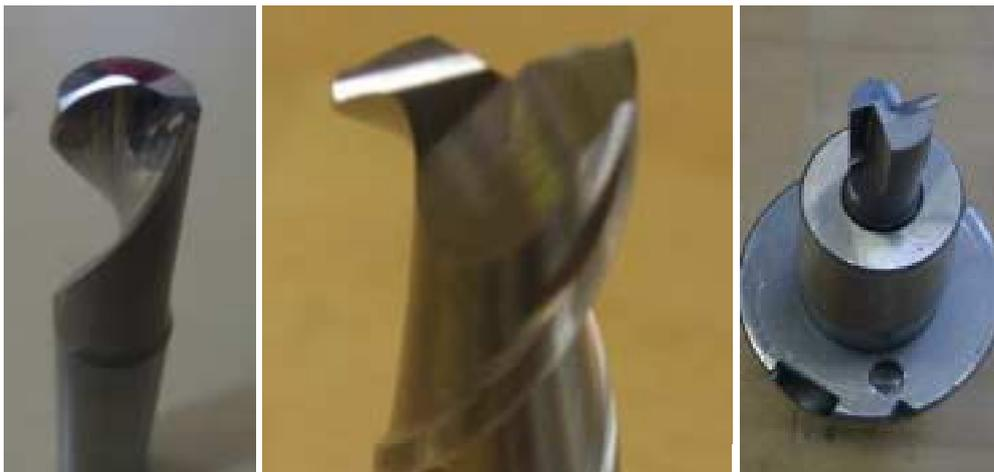
**Abbildung 11.3.18: Von links nach rechts: Schlichtfräser nach 30 Proben: Vollhartmetall mit DLC-Beschichtung, Schruppfräser nach 150 Proben: Vollhartmetall Feinstkorn unbeschichtet, beide Herst. Fa. Kennametal Hertel; PKD Schafffräser, Herst. MAPAL**
