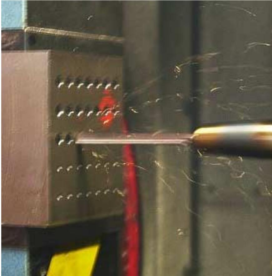
**Abbildung 11.3.21: Bohren in St52**
