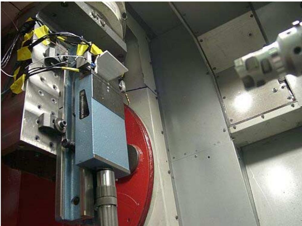
**Abbildung 11.3.19: Mit Thermoelementen und Wegsensoren bestücktes Versuchswerkstück am wbk**
