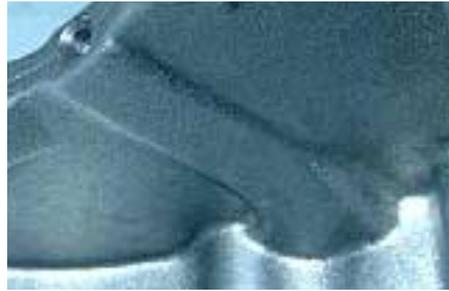
**Abbildung 11.3.8: Darstellung der 2 mm Bohrung als kritischsten Bearbeitungsprozess für die Trockenlegung**
