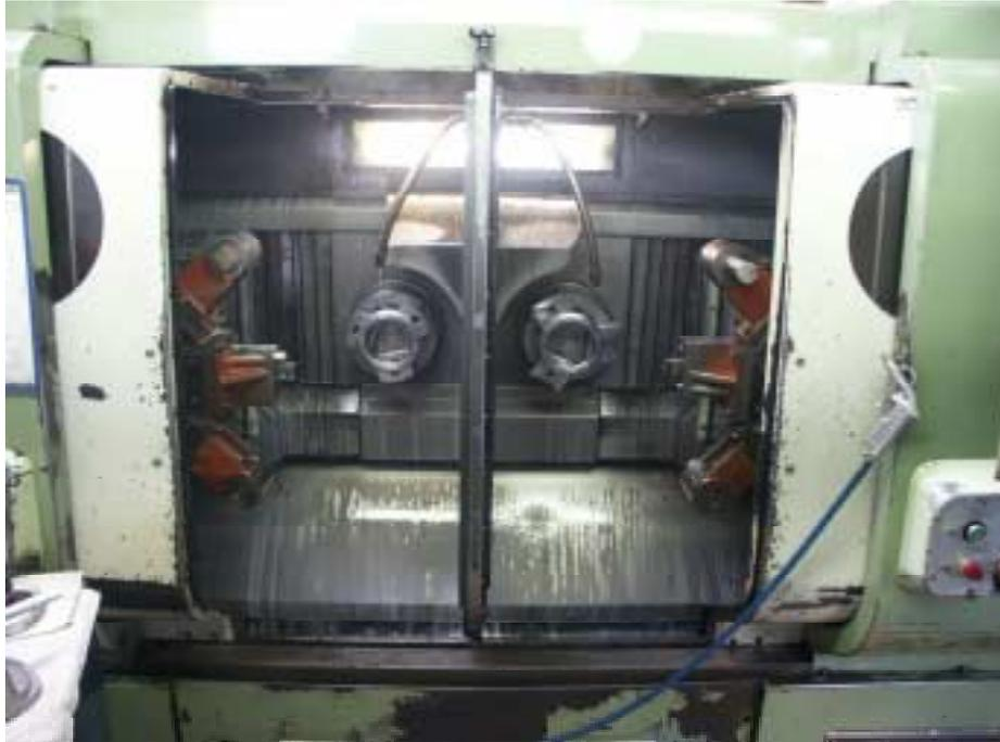
**Abbildung 11.1.4: Zweispindlige Drehmaschine**
