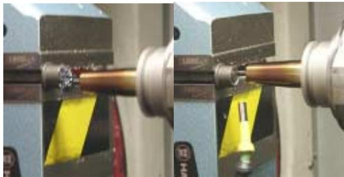
**Abbildung 11.3.1: Spanabtransport bei Erreichen der Endtiefe der Nut, links ohne MMS, rechts mit äußerer Aerosolzufuhr**
