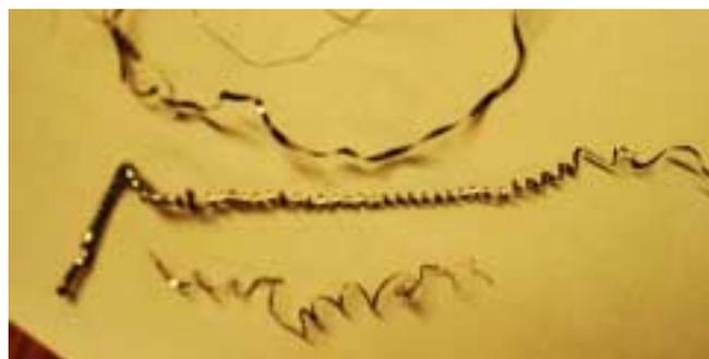
**Abbildung 11.3.24: Unterschiedliche Spanformen, erfolgreicher Wendelspan in der Bildmitte**
