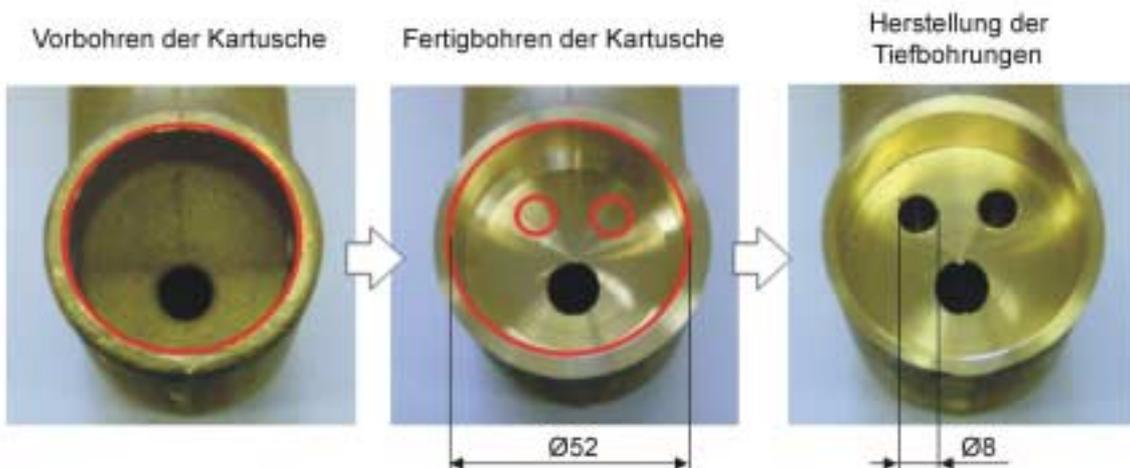
**Abbildung 11.2.12: Ausgewählte Bearbeitungsoperationen an der Messingkartusche**
