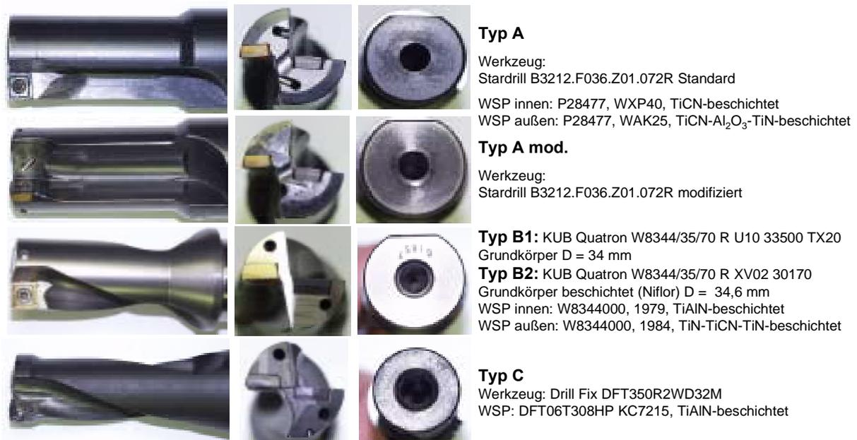
**Abbildung 11.4.14: Ausführungsvarianten der beim Trockenbohren mit MMS eingesetzten mit Wendeschneidplatten bestückten Bohrwerkzeuge**
