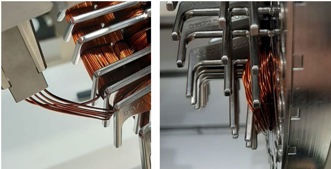
Abbildung 114: (links) Verlegefehler im Wickelkopf: Ein Draht liegt auf der falschen Seite des Wickelwerkzeugs; (rechts) Plastische Verformung des Wickelwerkzeugs durch Einwirkung des Drahtes
