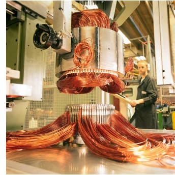
Abbildung 6: Vorbereitung der Wicklung Bild (l.) nach [Tzs-90]; Einziehen der Wicklung (Bildquelle (r.): Otto Rist GmbH)
