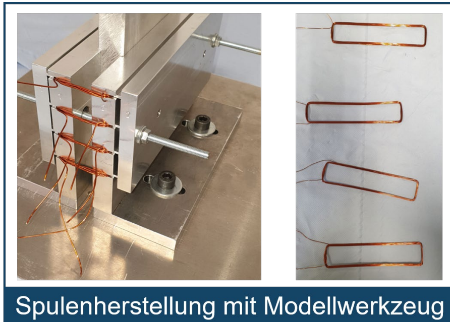
Abbildung 71: Modellwerkzeug zur Herstellung von Kompaktwicklungen (links), erzeugte Spulen der Kompaktwicklung mit lagengenauer und kompaktierter Anordnung in aktiver Länge der Spulen in der Nut (rechts)
