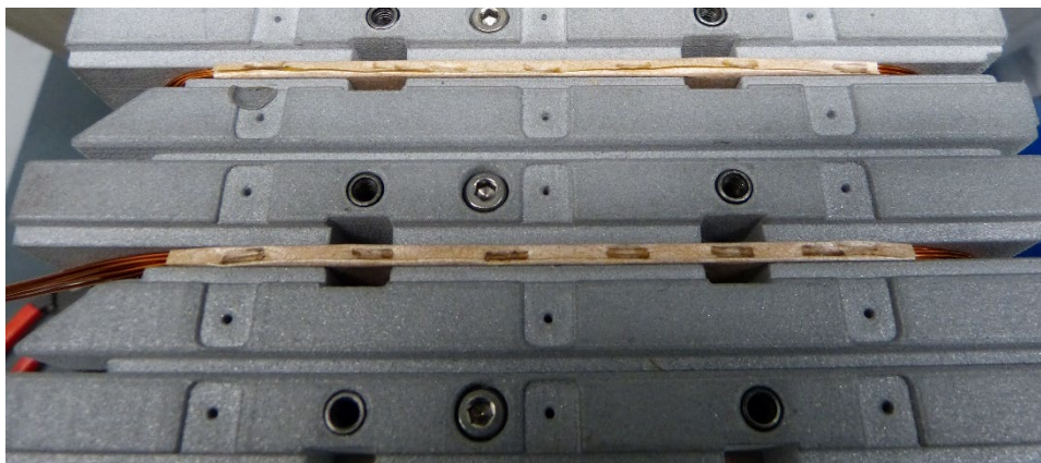
Abbildung 83: Wickelwerkzeug mit verschlossenen Spulen
