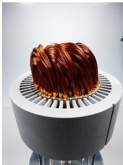
Abbildung 73: Mit Spulen gefülltes Innenwerkzeug
