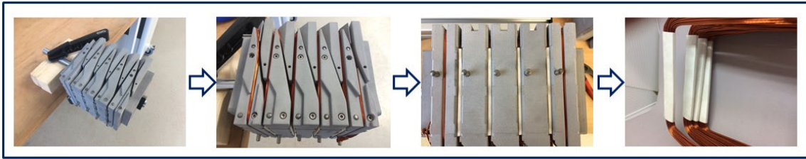
Abbildung 64: Wickeln einer Spulengruppe
