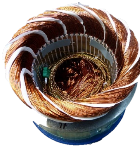
Abbildung 81: Wickelkopfisolation zwischen den Phasen
