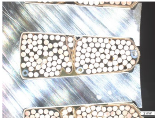
Abbildung 76: Querschnitt einer befüllten Statornut
