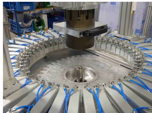
Modul 3: Im Umbau für die Übergabe der Spulen mit 3-eckigem Wickelkopf
