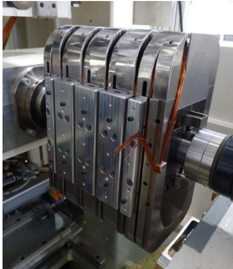
Abbildung 93: Wickelwerkzeug mit 3-eckigem Wickelkopf, eingespannt in die LWS/S
