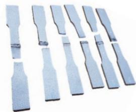
4.13 PROBEBRUCHSTELLEN IM SUBSTRAT
