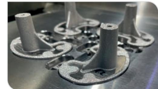
Hybrid-additiv gefertigte Knieimplantate in einer speziell angepassten Bauplattform (Foto: FIT AG/Chrupala)
