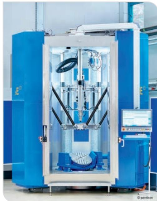
In Beschaffung befindliche Hochgeschwindigkeits-Laser-Auftragsschweiß-Anlage pE3D der Ponticon GmbH (Foto: Ponticon)
