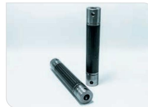
Versuchskörper für Torsionsprüfungen aus dem FKVShaft Projekt (Foto: wbk)
