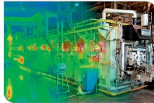
Thermografieaufnahme Durchstoßofen zur energetischen Analyse
