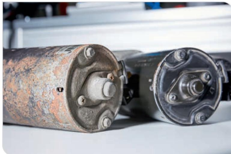
Korrosion und unbekannte Bauteilzustände als Herausforderungen für das automatisierte Remanufacturing und die Umsetzung der Kreislaufproduktion (Foto: wbk)
