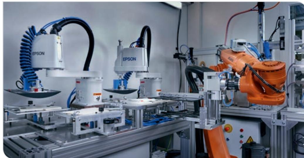
Prozessmodule zur variantenflexiblen Produktion von Batteriezellen im SmartBatteryMaker (Foto: Amadeus Bramsiepe, KIT)
