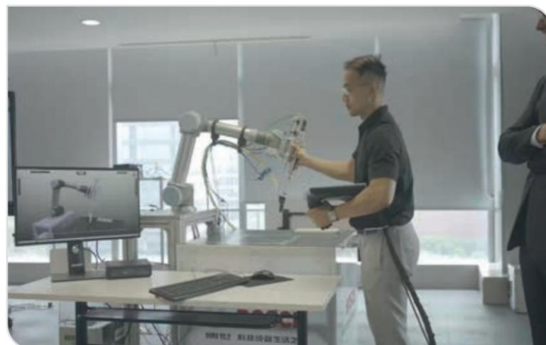
Der digitale Zwilling in der Robotik ermöglicht eine Off-line Programmierung, erlebbar im GAMI Innovation Center (Foto: wbk/GAMI)
