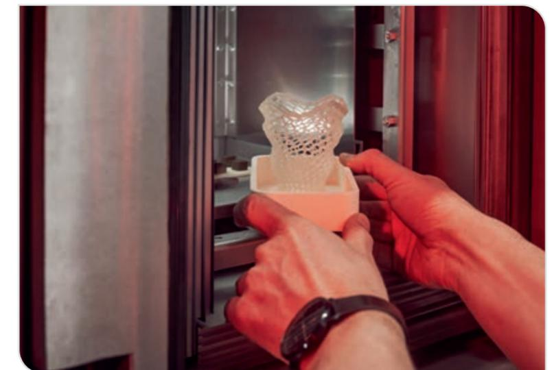
Additiv hergestelltes Bauteil vor dem Sintern (Fotos: wbk)
