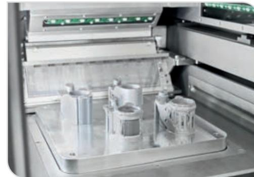
Bauplatzform mit Bauteilen in einer PBF-LB-Anlage
