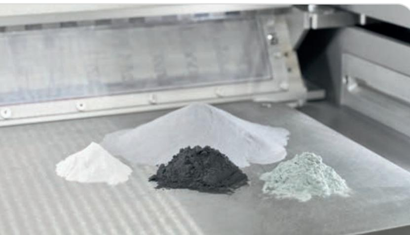
Verschiedene keramische und metallische Ausgangspulverwerkstoffe (Foto: Amadeus Bramsiepe, KIT)
