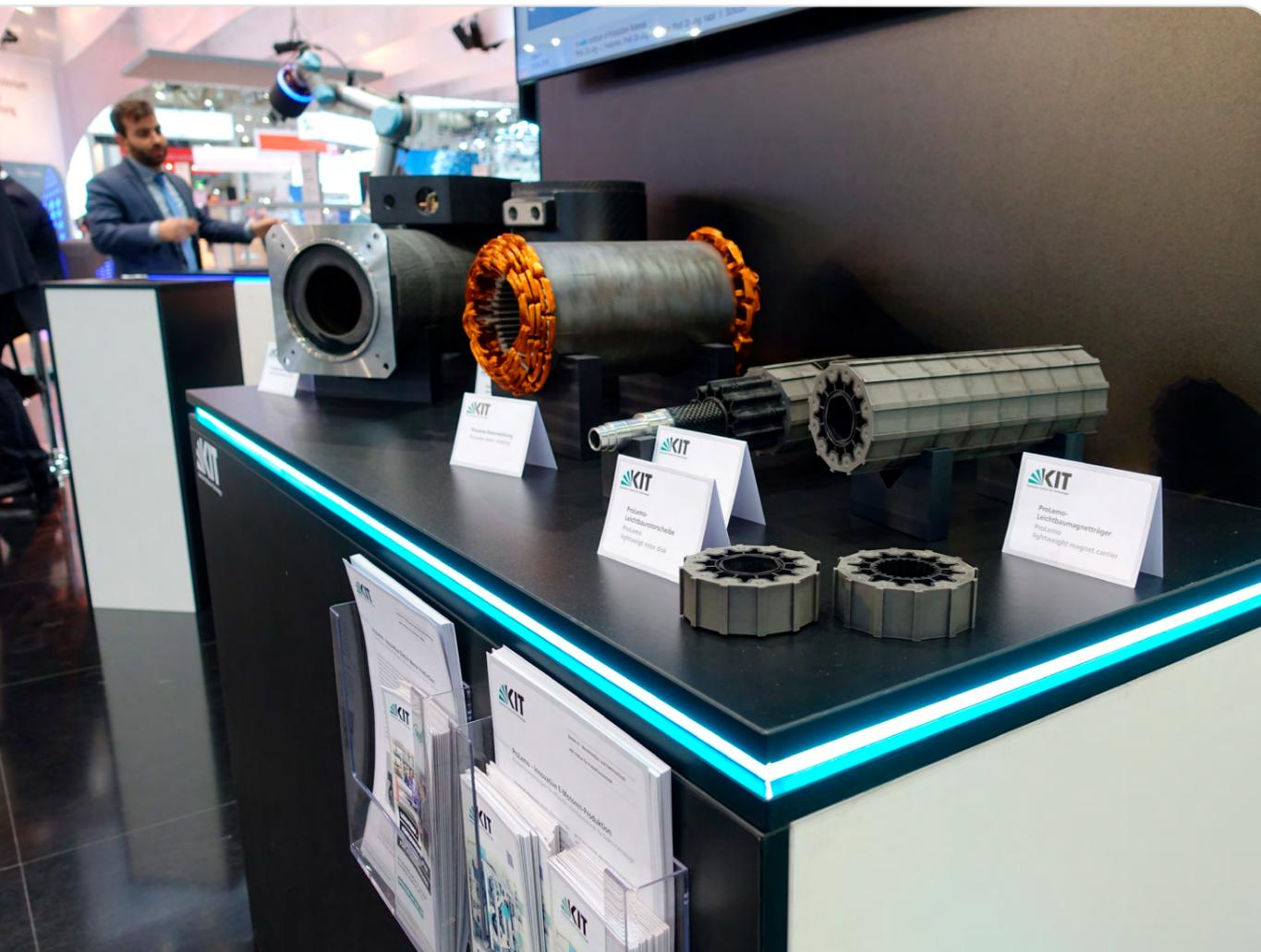
Exponate auf der Hannover Messe: spritzgegossene Rotorscheiben, CFK-Stahl-Hybridwelle, automatisiert gewickelter Stator und Leichtbaugehäuse.
