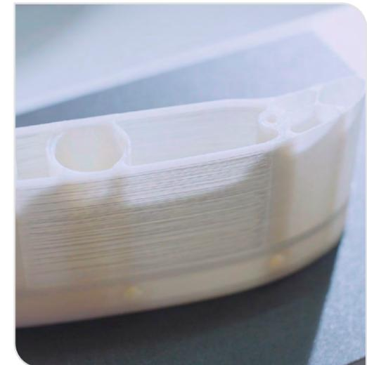
Freigeformter faserverstärkter DRS-Aktor für KA-Racelng.
