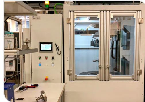
Prototypische Stream Finishing Maschine mit hoher Antriebsleistung.
