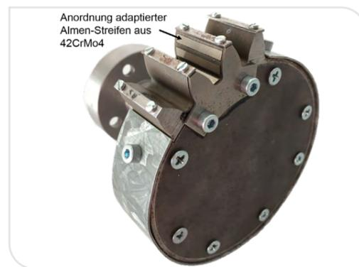
Schnelltest in geometrischer Analogie zu einem evolventenverzahnten Stirnrad.
