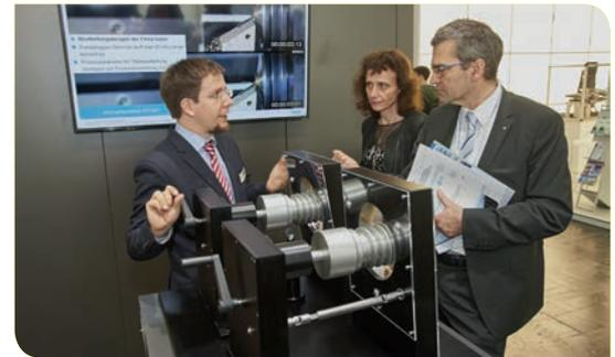
Erklärung des Dreh-Wirbelns am Schraubenmodell des wbk
