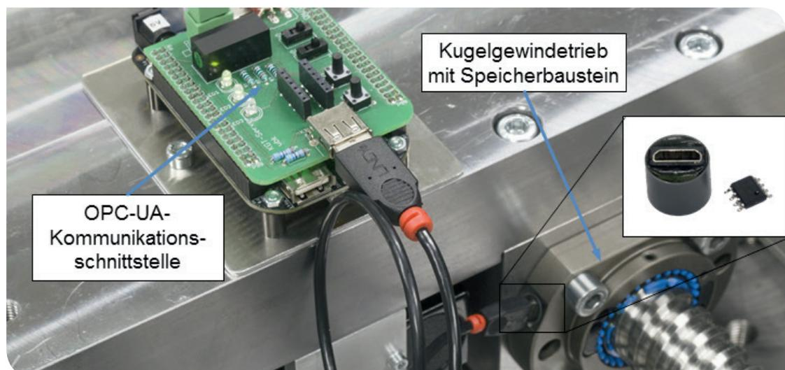
Kugelgewindetrieb mit OPC-UA-Kommunikationsschnittstelle
