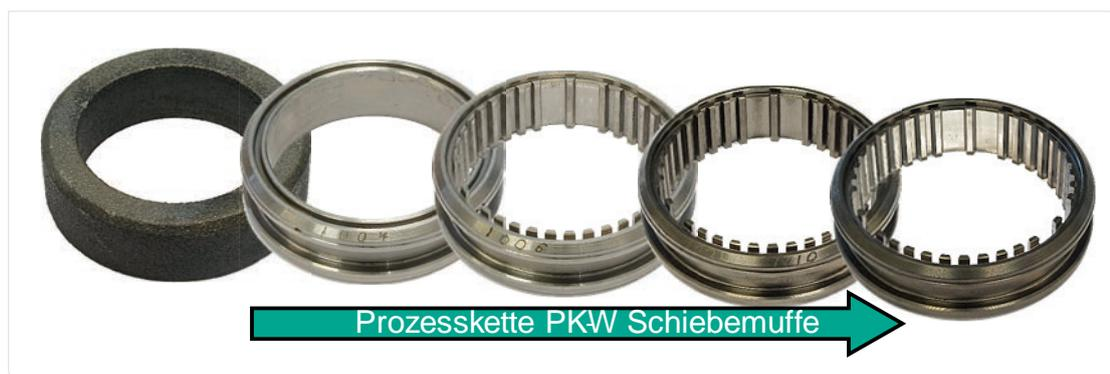
Untersuchte Prozesskette zur Herstellung eines Bauteils mit komplexer Innenverzahnung durch Trockenräumen
