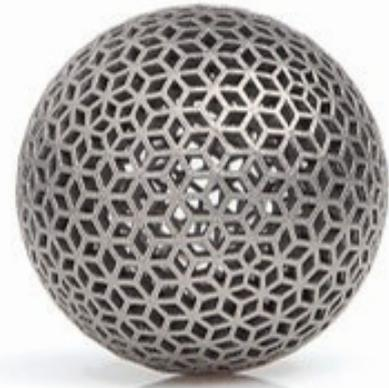
Bauteil hergestellt durch selektives Laserschmelzen
