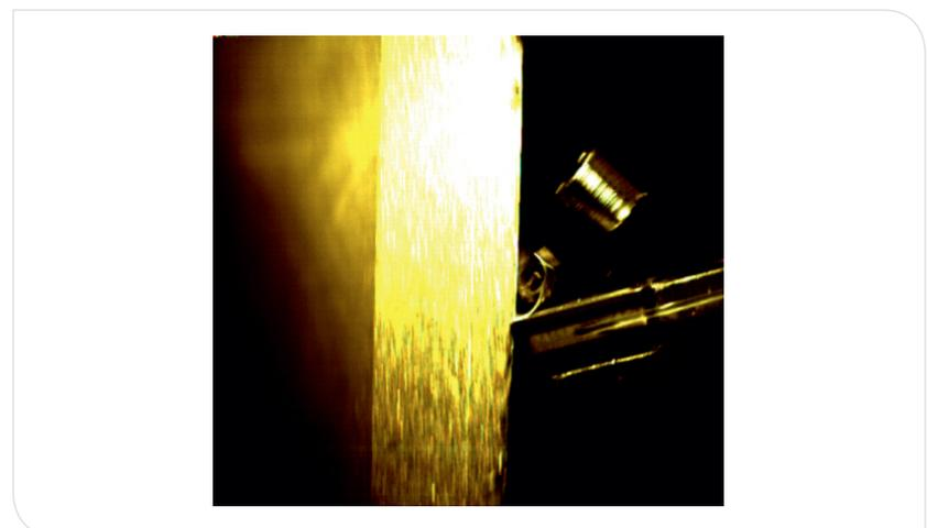
Orthogonaler Schnitt von Inconel bei  $v_c = 60$  m/min und  $h=0,1$  mm parallel zu den Schichten des additiv gefertigten Bauteils
