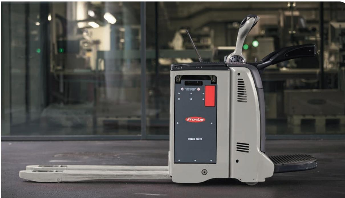
Demonstrator: Mobile PEM-Brennstoffzelle im Flurförderzeug, Bildquelle: © Fronius International GmbH 2016
