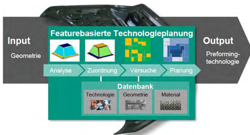
Featurebasierte Technologieplanung für das Preforming von Faserverbundbauteilen
