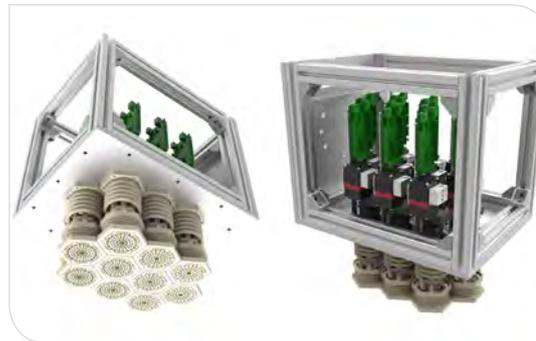
Segmentierter Drapiergreifer mit einzeln ansteuerbaren Pixeln und integrierter Sensorik
