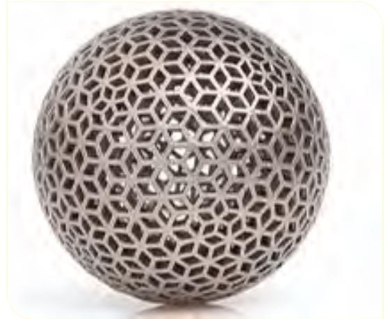
Bauteil hergestellt mit selektivem Laserschmelzen
