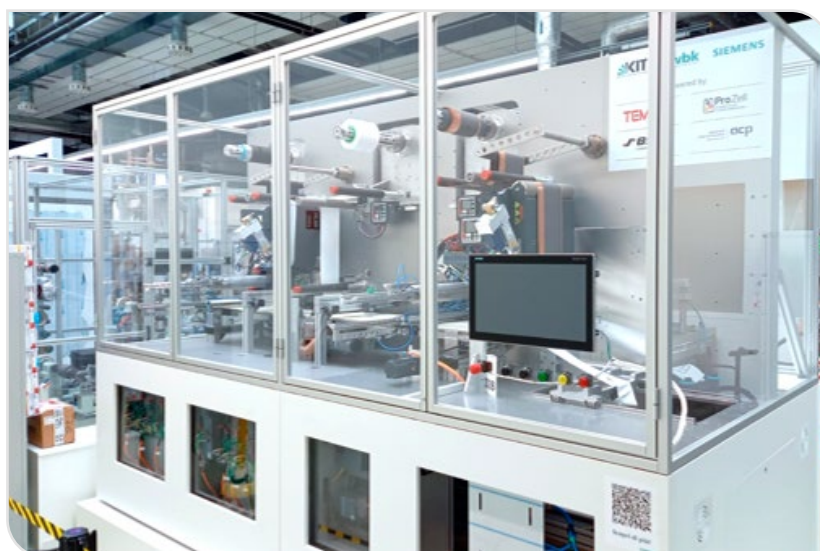
Neuartiges Maschinenkonzept EXINOS zur kontinuierlichen und flexiblen Batteriezellassemblierung als Anlagendemonstrator sowie der zugrundeliegende Digitale Anlagenzwillig (Foto: wbk)
