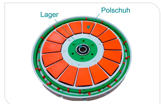
Axialflussmaschine mit Polschuh und Lagersitz (Abbildung: wbk)
