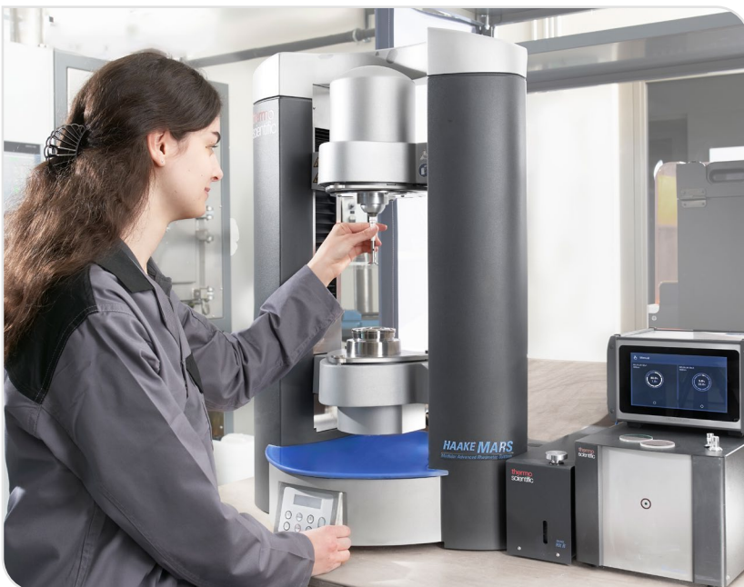
Charakterisierung von LED-Schlickern am Rheometer
