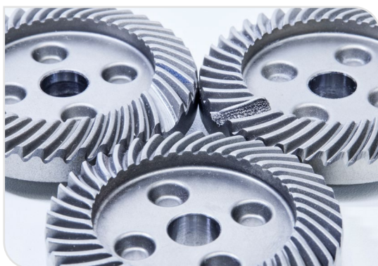
Exemplarische Prozesskette in der Bauteilaufarbeitung. Defekter Zahn entfernt (links oben), neu aufgebracht (rechts oben) und spanend nachbearbeitet (unten). (Foto: Beckhoff)
