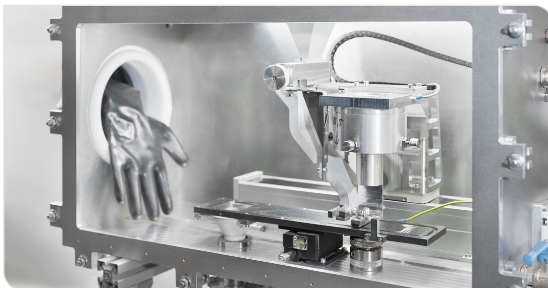
Eigenentwickelter Versuchsstand zur Untersuchung des Pulverauftrages im Pulverbett-basierten Laserstrahlschmelzen (Foto: Amadeus Bramsiepe, KIT)
