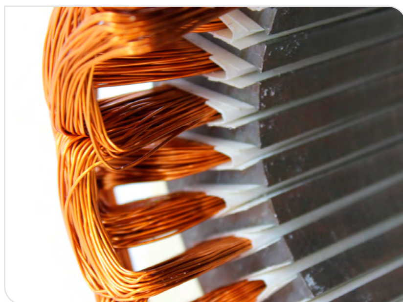
Mit dem Fünf-Achs-Nadelwickeln hergestellter Stator eines Elektromotors
