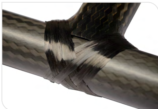
Profilverbindung mittels Fügewickeln
