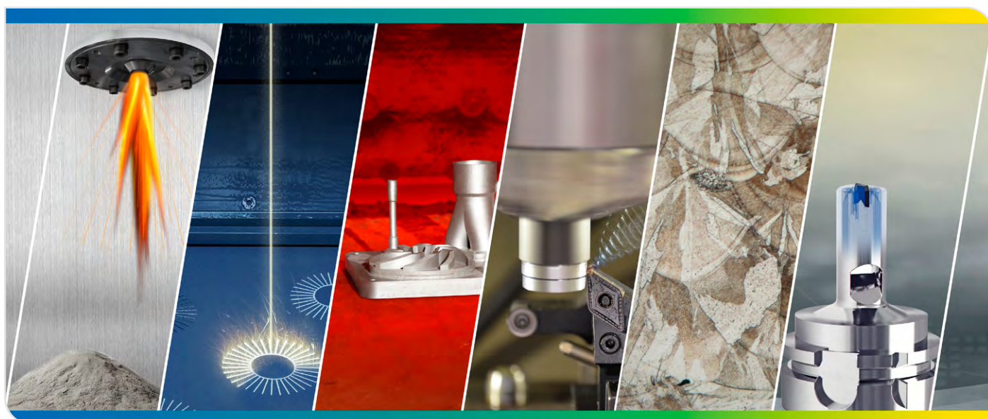
Untersuchte Prozesskette: v.l.n.r Metallpulverherstellung durch Verdüsung, LPBF-Prozess, Wärmebehandlung, zerspanende Nachbearbeitung, Materialcharakterisierung, fertiges Bauteil
