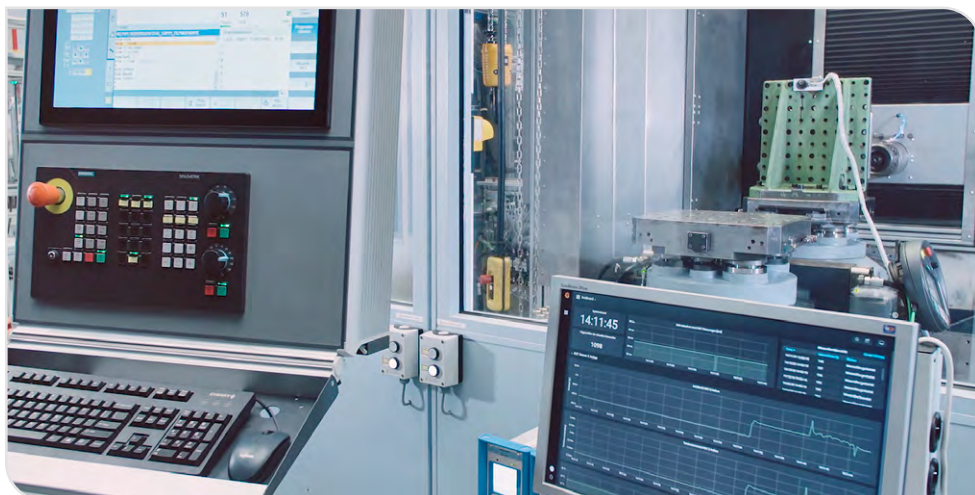
Werkzeugmaschine am wbk mit nachgerüsteten Industrie-4.0-Anwendungen
