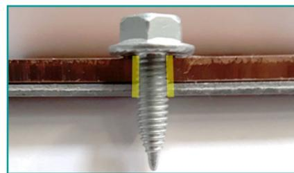
Schematische Darstellung einer Fließlochschraube, in Gelb ist die stoffschlüssige Verbindung gekennzeichnet.
