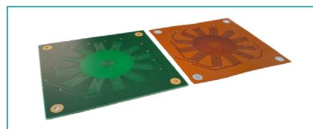
Starre (links) und flexible (rechts) Spulennetze von Wirbelstromsensoren zur Integration in flache und gekrümmte Formwerkzeuge
