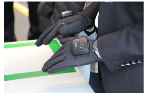
Intelligente Technologien wie zum Beispiel Handschuhe mit Sensoren erfassen automatisch Arbeitsschritte und leiten die Informationen an das gesamte Produktionssystem weiter. (Foto: KIT)
