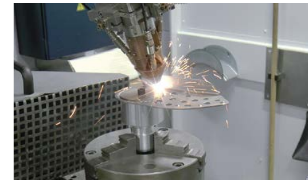
3.13 VERSCHLIESSEN DER ENTLASTUNGSSCHLITZE MIT LASER-METAL-DEPOSITION
