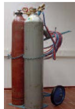
图 22：气瓶车上装的独立气瓶（参考[17]）
