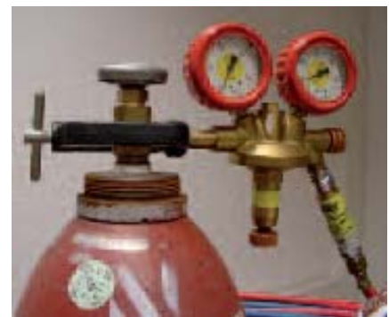
图 23: 安装好的乙炔瓶 (参考[17])
