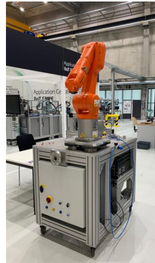
Abbildung 3.21: CAD-Modell des Handhabungsmoduls (links) und realer Aufbau des Handhabungsmoduls in der Karlsruher Forschungsfabrik (rechts).
