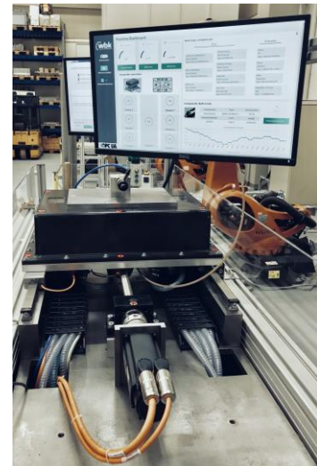
Demonstrator zur Anpassung der Eigenfrequenzen von Werkzeugmaschinen (EMO 2017)
