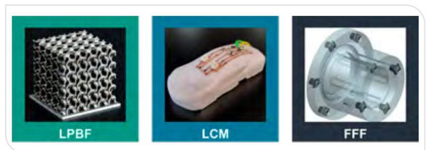
Beispielbauteile, die mittels der drei für den ICM relevanten additiven Fertigungsverfahren hergestellt wurden
