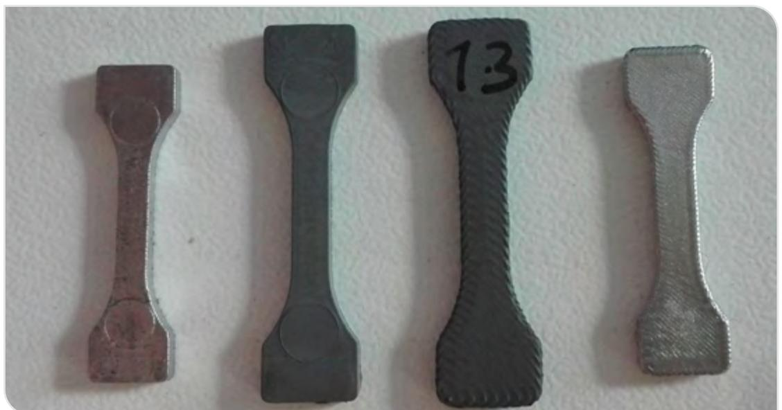
Spritzgegossene Zugproben (links) und freigeformte Zugproben
