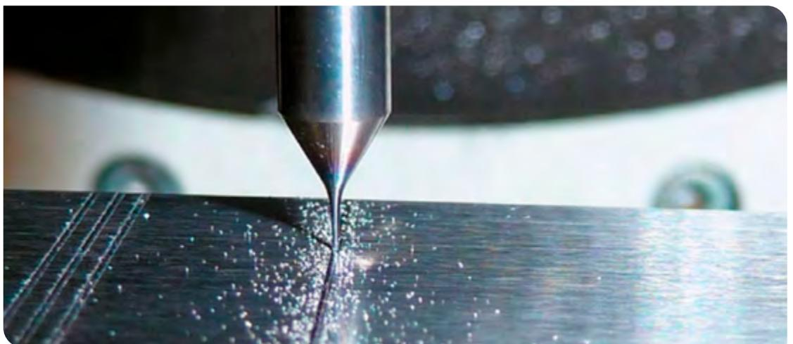
Mikrofräsen in Stahl mit einem 300 µm Hartmetallfräser
