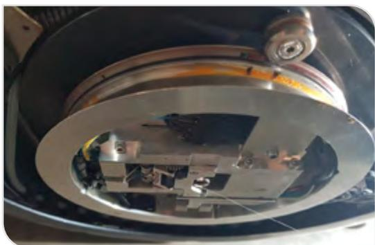
Mechanik für die Implementierung von Fasern in die additive
