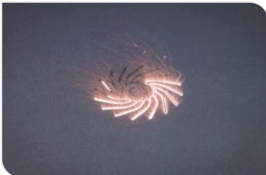
Laser-Pulverbettenschmelzen eines Impellers
