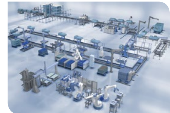
Layout einer Batteriemontage (Dür)
