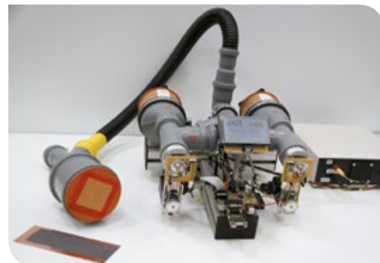
Kraft geregelter Niederdruckflächengreifer zur Handhabung keramischer Grünfolien
