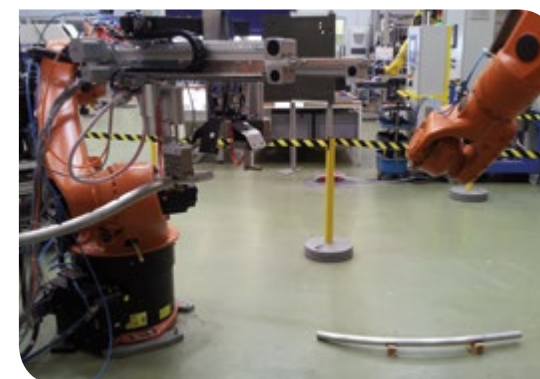
Vorrichtungsfreie Anordnung von Fügepartnern in der Montagezelle
