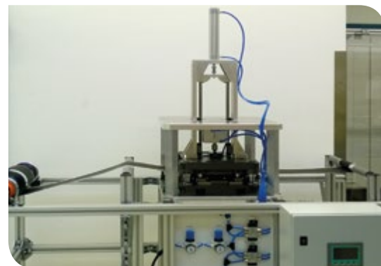
Versuchstand für das Stapelbildungsverfahren Cut and Place
