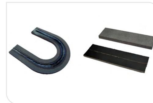
LS-Bauteile mit Endlosfaser (Foto: wbk)
