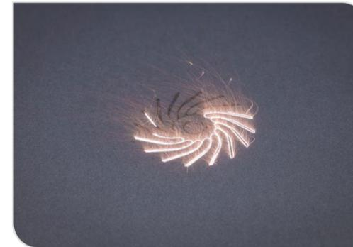
Laser-Pulverbetttschmelzen eines Impellers
