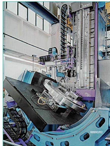
Abbildung 1: Turbinenräummaschine
