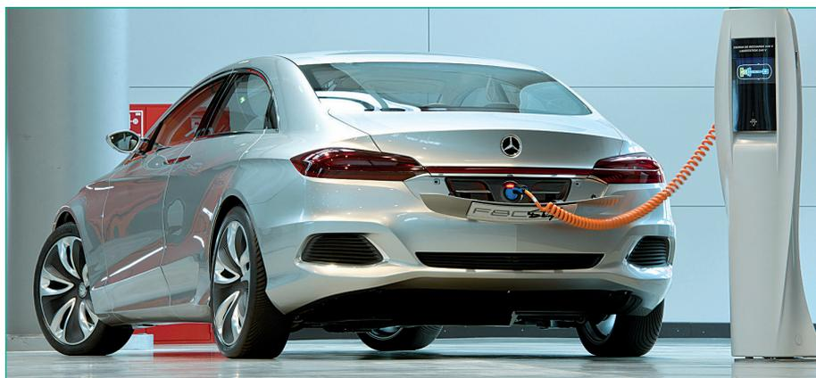
Abbildung 1: Der F 800 Style Plug-in HYBRID kann in der Stadt rein elektrisch fahren. Die Lithium-Ionen-Batterie lässt sich an Ladestationen oder Haushaltssteckdosen aufladen (Foto: © Daimler AG).
