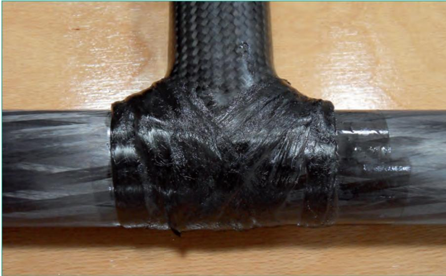
Abbildung 1: Prototypisch durchgeführte Wickelverbindung
