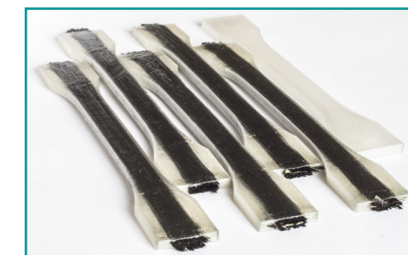
Carbonfaser gefüllte Zugproben
