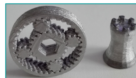
Freigeformte Metallbauteile nach dem Sintern
