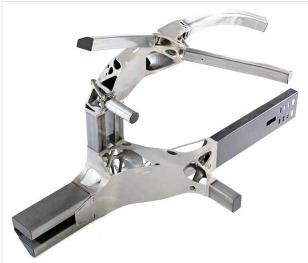
Abb. 45: Karosseriestruktur mit individuellen Verbindungselementen
