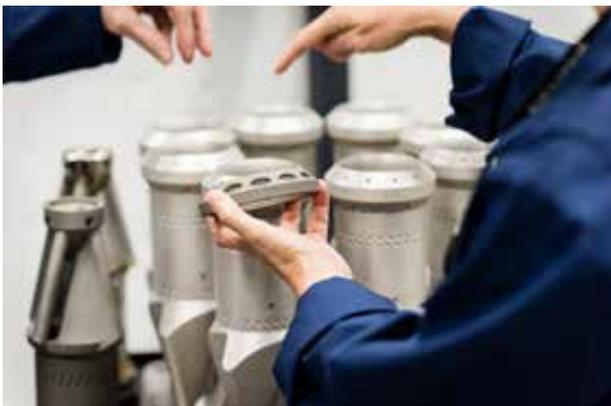
Abb. 23: Fertigung von Brennerspitzen mit LBM im schwedischen Finspong (Quelle: Siemens AG)
