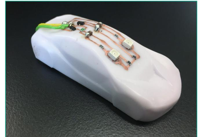
Demonstrator mit dreidimensionaler Leiterbahn auf einem keramischen Grundkörper
