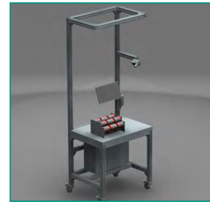
Modell des Demonstrators mit optischer Überwachung der Montage
