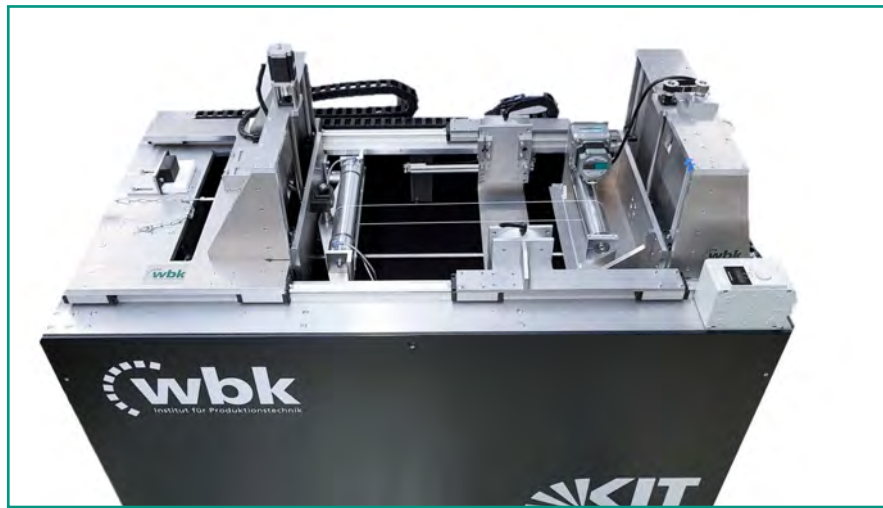
Demonstrator zur Untersuchung von Wirkzusammenhängen bei der Verarbeitung dickschichtiger Elektroden am wbk Institut für Produktionstechnik
